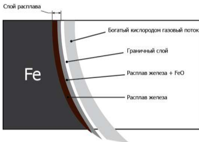
Рис. 2 Схематический вид реза при резке в кислороде
